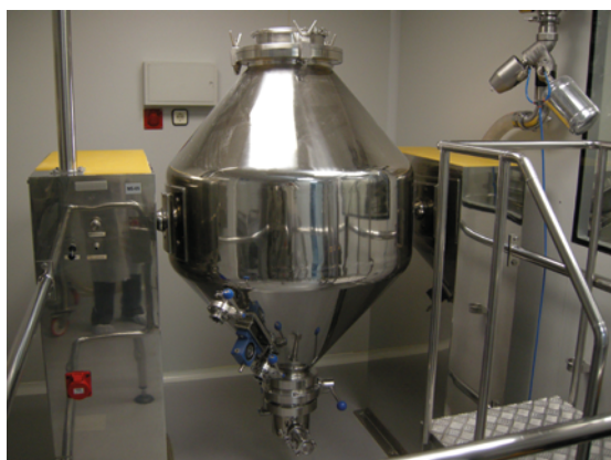
Блендер двухконусного типа с автоматической системой загрузки и выгрузки
