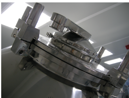
Отверстие для вакуумной загрузки
